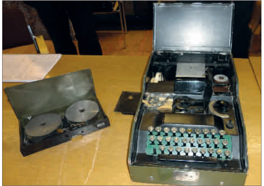
Ruotsalaisvalmisteisen Hagelin-salakirjoituskoneen käyttökokemuksista Velanderille syntyi ajatus Mirristä, joka sai nimensä kissan kehäämistä muistuttaneesta moottorin äänestä. Kuvassa Mirri ja laitteen yläosasta irrotettu reikänauhakasetti, johon salaustekniikka perustui.
